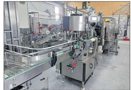
Die Abfüllanlage kann 3.000 Flaschen pro Stunde füllen.
