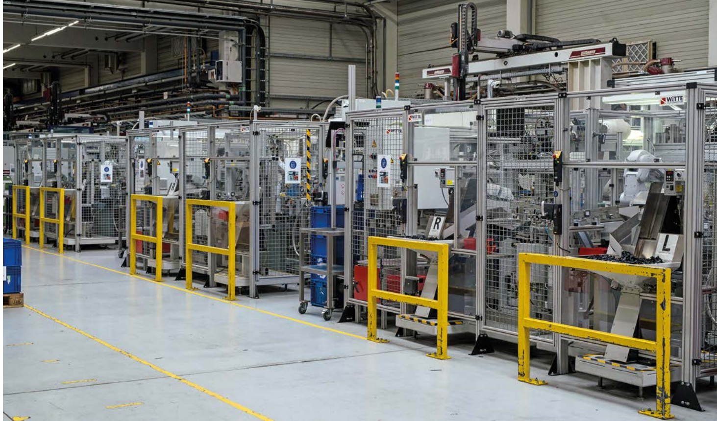
Der moderne Spritzgießmaschinenpark verfügt über 34 Maschinen; hier entstehen täglich rund 50.000 Türgriffe für die Automobilindustrie.
