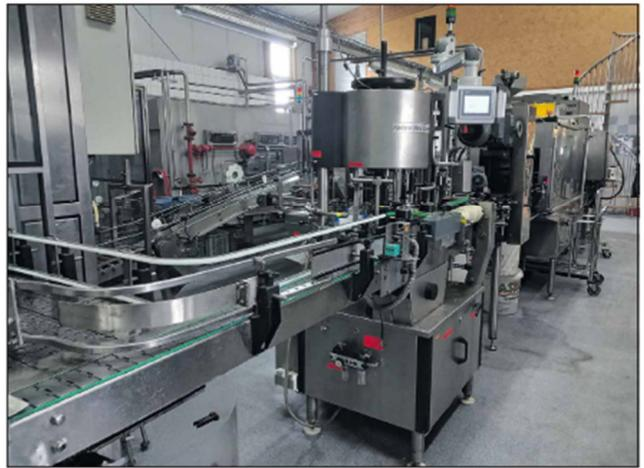
Kurzer Blick in die Abfüllanlage...sie kann 3.000 Flaschen pro Stunde füllen! Kelterei Marc Conrad – ein leistungsstarker Familienbetrieb.
