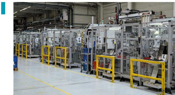
Der moderne Spritzgießmaschinenpark verfügt über 34 Maschinen; hier entstehen täglich rund 50.000 Türgriffe für die Automobilindustrie.
