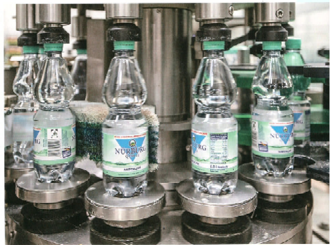
Vier Abfüllanlagen für PET- und Glasflaschen befüllen neben Mineralwasser ein großes Sortiment an Limonaden und Fruchtsaftgetränken.
